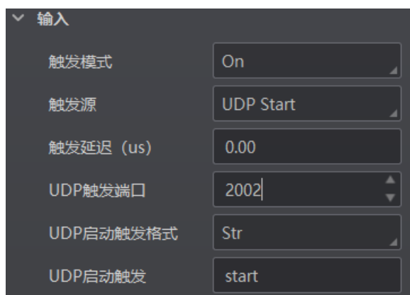
图4-54 UDP 触发参数设置
