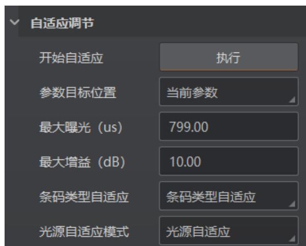
图4-24 自适应调整参数
