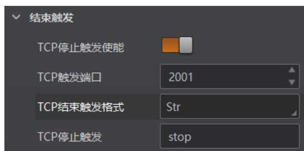
图4-58 TCP 停止触发
