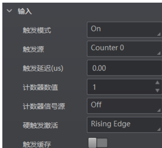
图4-52 计数器触发参数设置
