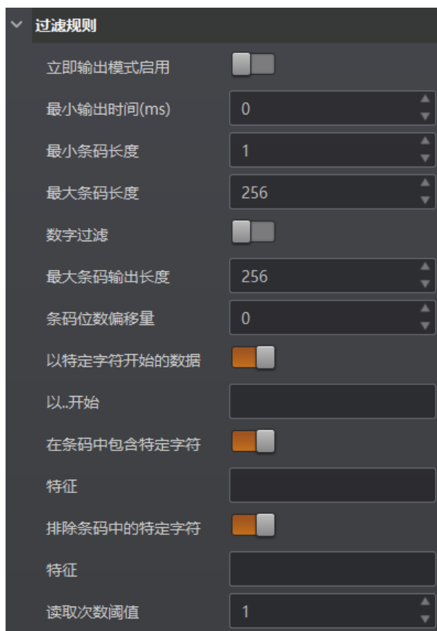
图4-90 普通过滤模式过滤规则参数
