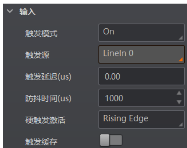
图4-49 外部触发参数设置
