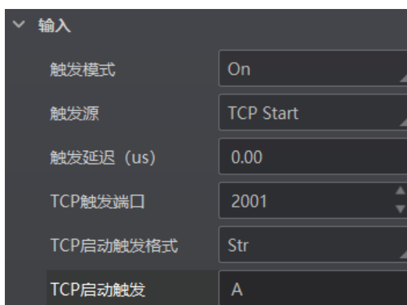
图4-53 TCP 触发参数设置
