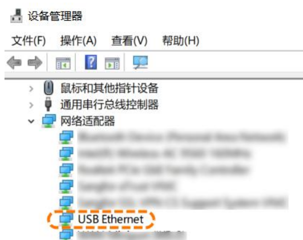
图3-8 驱动安装正常
