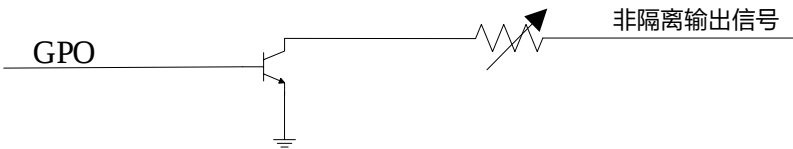
图6-3 非隔离输出内部电路
