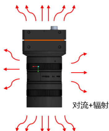
图4-9 线阵相机无任何附件散热措施下的散热说明
