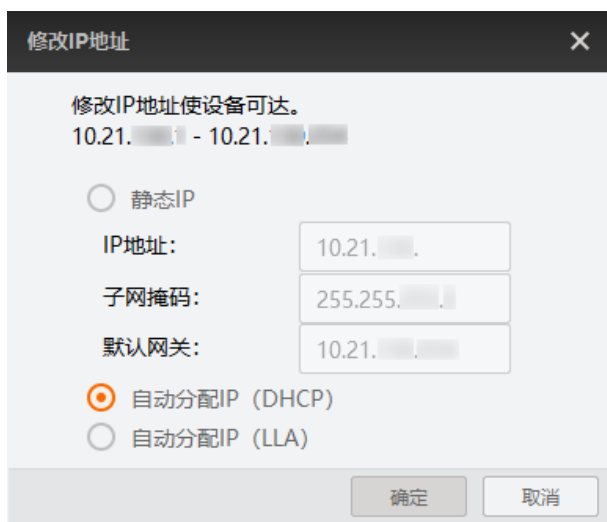
图3-12 修改 IP 地址
