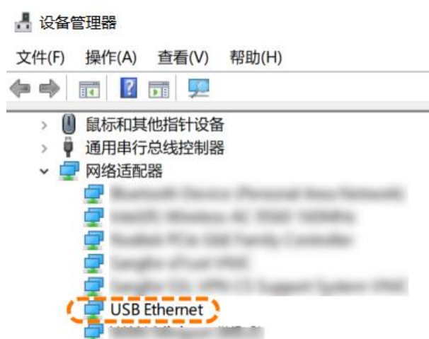
图3-8 驱动安装正常
