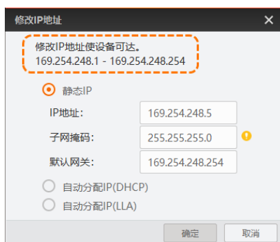
图6-8 修改 IP 地址
