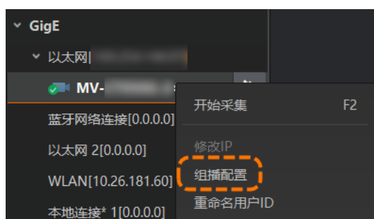
图13-9 连接状态下的组播配置
