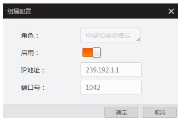
图13-10 连接状态下的相机组播设置
