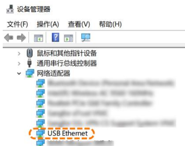
图6-7 驱动安装正常
