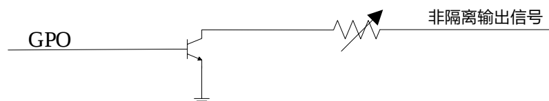
图5-10 非隔离输出内部电路
