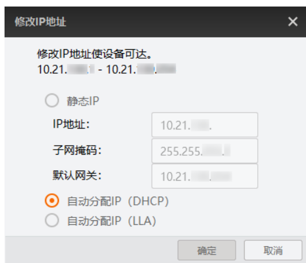
图6-11 修改 IP 地址
