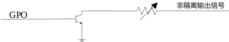
图4-3 非隔离输出内部电路
