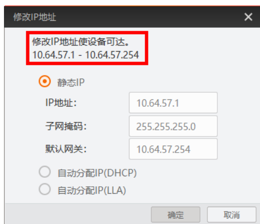
图6-4 修改 IP 地址
