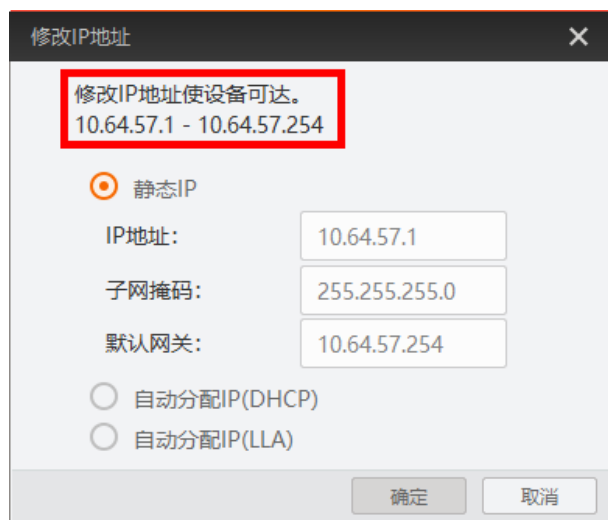
图5-5 修改 IP 地址
