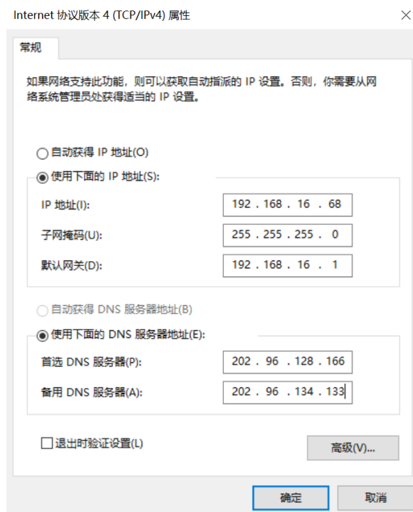
图5-4 PC 网口 IP 配置
