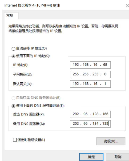
图5-3 PC 网口 IP 配置
