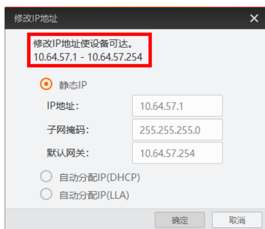
图5-4 修改 IP 地址
