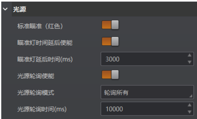
图6-24 三色补光款设备光源轮询参数设置
