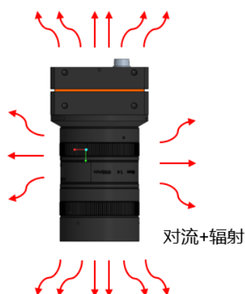
图4-4 线阵相机无任何附件散热措施下的散热说明
