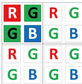
图10-17 彩色相机水平垂直 Binning 设置为 2 × 2
