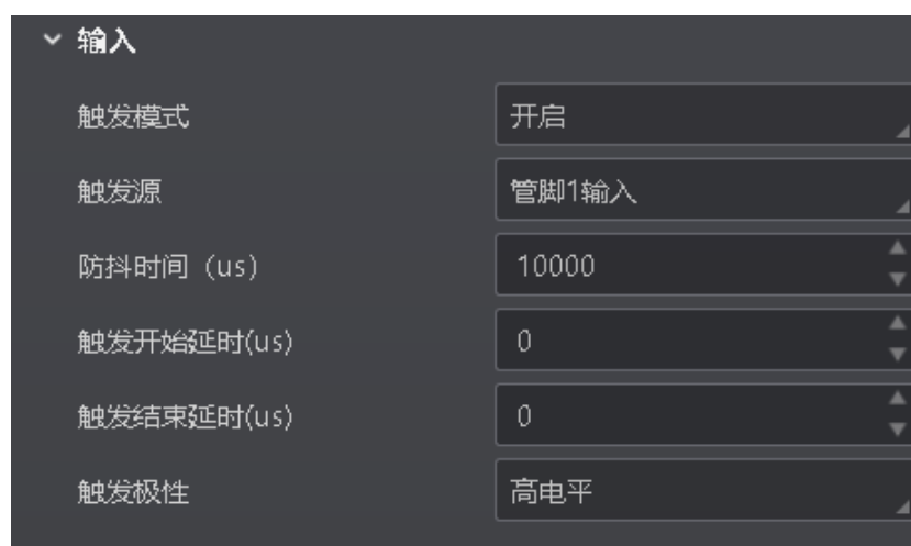
图6-30 硬件触发参数设置
