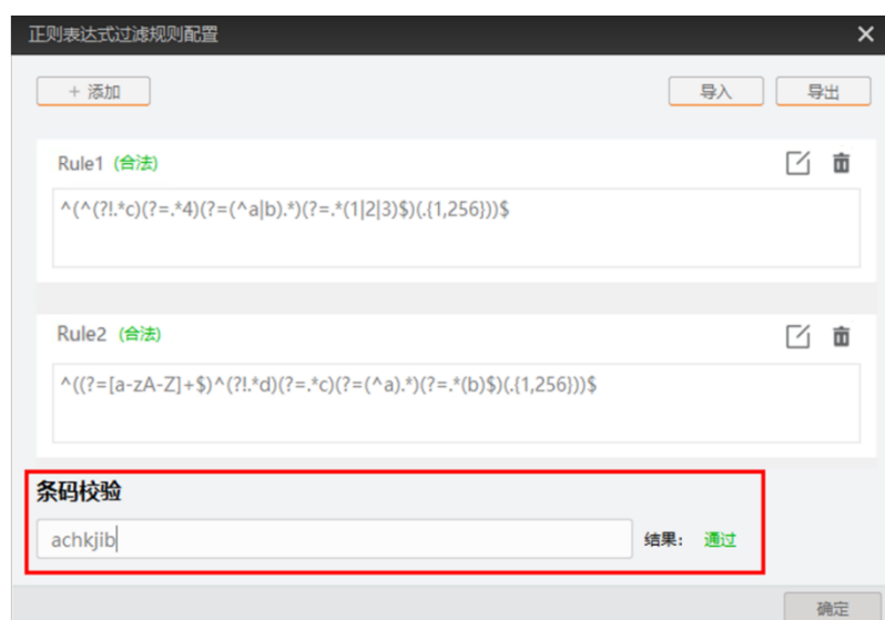
图6-13 过滤规则条码校验
