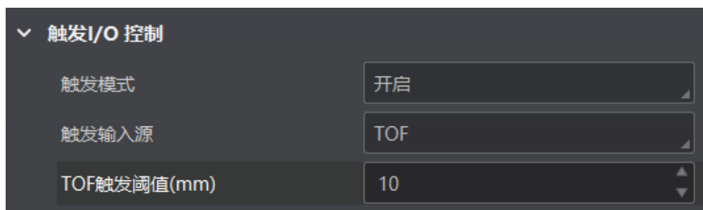
图6-34 TOF 触发参数设置
