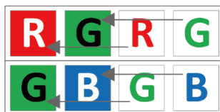
图10-15 彩色相机水平 Binning 设置为 2
