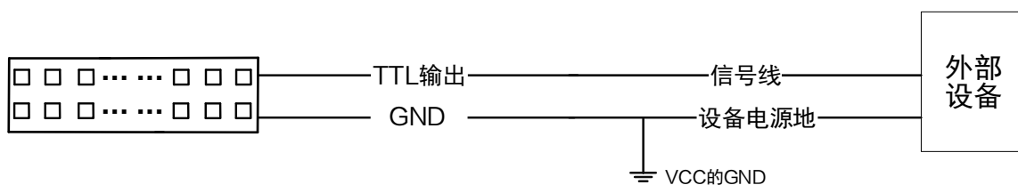
图5-15 TTL 输出直连外部设备
