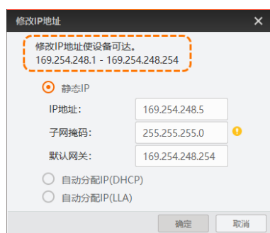
图 6-10 修改 IP 地址
