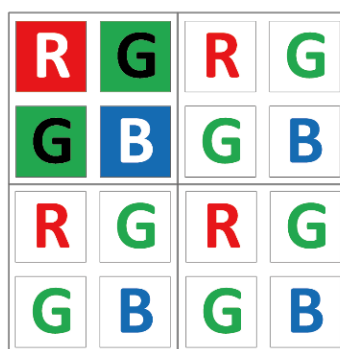
图 11-9 彩色相机水平垂直 Binning 设置为 2 × 2
