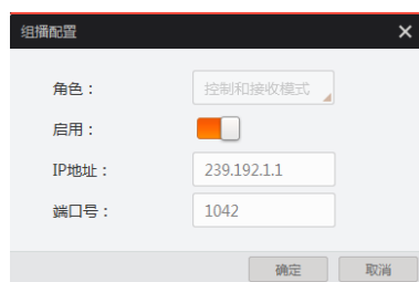
图 13-11 连接状态下的组播配置
