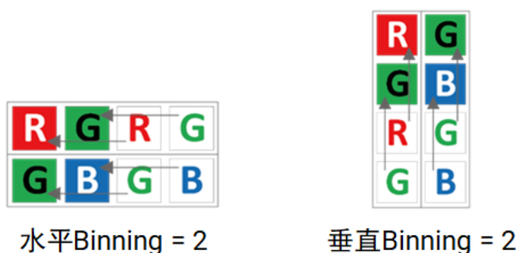
图 11-8 彩色相机 Binning 设置
