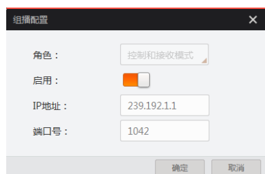
图 13-12 连接状态下的相机组播设置
