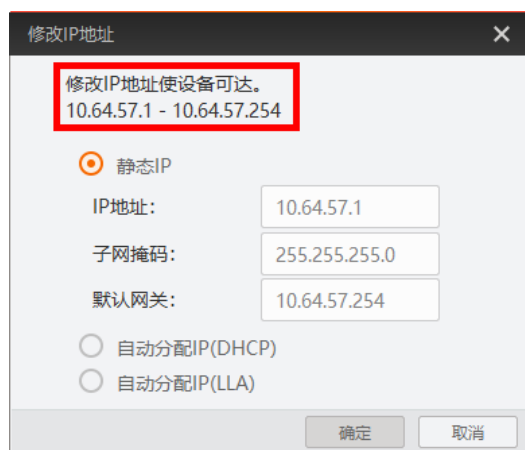
图6-4 修改 IP 地址
