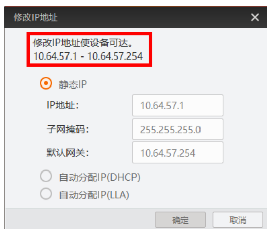
图5-4 修改 IP 地址
