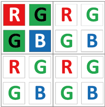
图 11-7 彩色相机水平垂直 Binning 设置为 2 × 2
