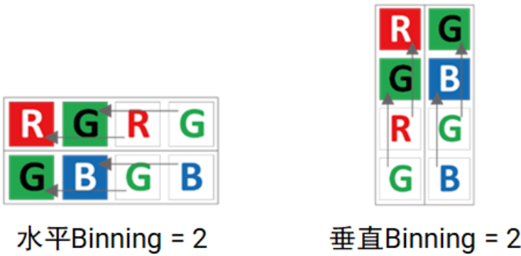
图 11-6 彩色相机 Binning 设置
