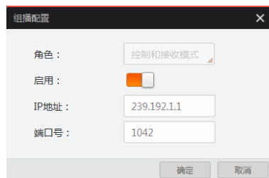
图 13-12 连接状态下的相机组播设置
