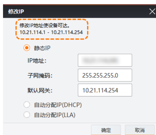
图4-5 修改 IP 地址
