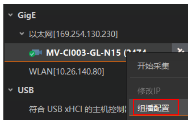
图8-20 连接状态下的组播配置
