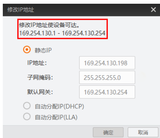
图3-6 修改 IP 地址
