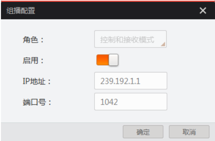
图8-21 连接状态下的相机组播设置
