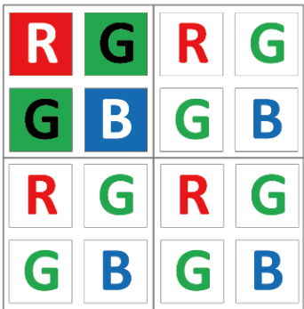
图 10-9 彩色相机水平垂直 Binning 设置为 2 × 2
