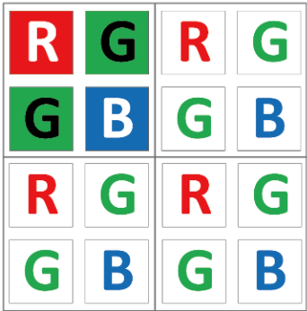
图 10-8 彩色相机水平垂直 Binning 设置为 2 × 2
