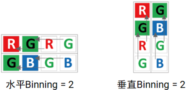
图 10-7 彩色相机 Binning 设置
