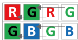
图9-12 彩色相机水平 Binning 设置为 2
