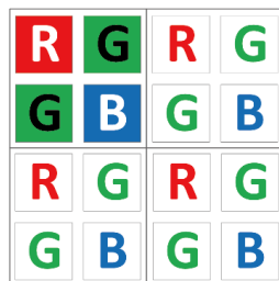
图9-14 彩色相机水平垂直 Binning 设置为 2 × 2
