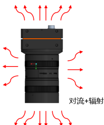
图4-6 线阵相机无任何附件散热措施下的散热说明
