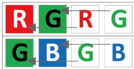
图10-10 彩色相机水平 Binning 设置为 2
