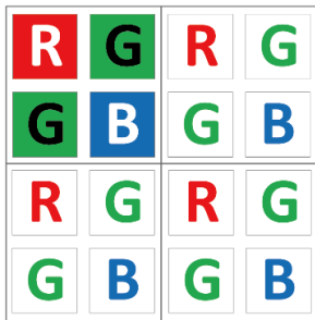
图10-12 彩色相机水平垂直 Binning 设置为 2 × 2
